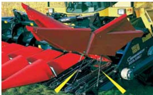
Промышленные газовые пружины ACE поддерживают мускульную силу и помогают Вам контролировать открытие и закрытие крышечек, капотов, откидных створок и экранов.
