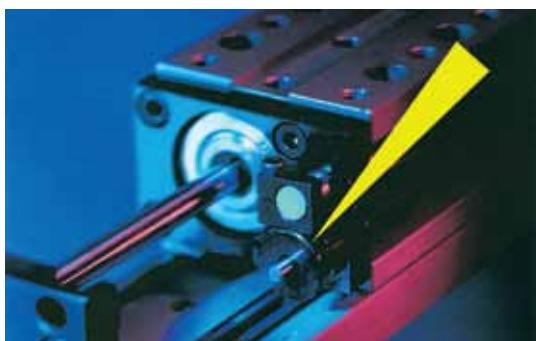
ACE промышленные амортизаторы – высококачественные демпферы для плавной остановки в конечном положении. Высокая эффективность и монолитная конструкция гарантируют долгую продолжительность службы; в том числе и в суровых окружающих условиях. Доступны в различном исполнении.
