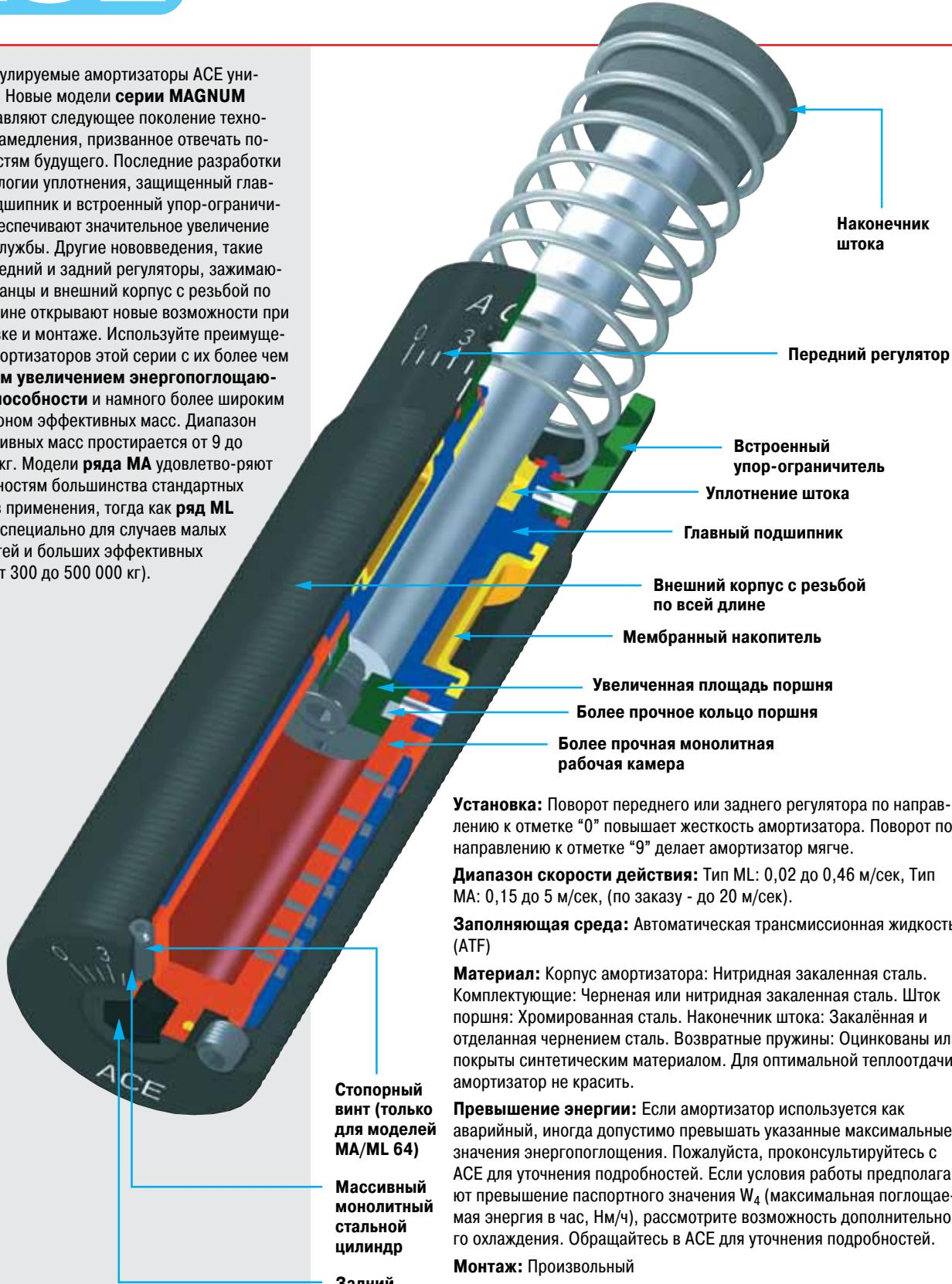
**Установка:** Поворот переднего или заднего регулятора по направлению к отметке "0" повышает жесткость амортизатора. Поворот по направлению к отметке "9" делает амортизатор мягче.
