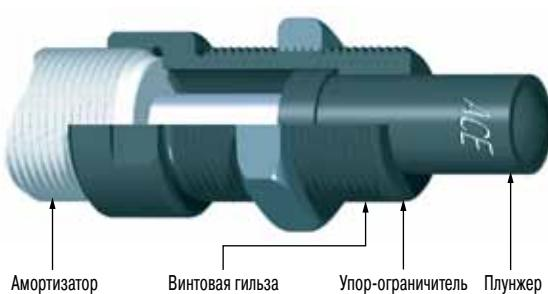
При отклонении направления груза от оси амортизатора более чем на 3° срок службы амортизатора значительно сокращается из-за повышенного износа подшипников штока. Дополнительный адаптер отклонения груза решает эту проблему. Закрепите адаптер на амортизаторе с помощью локтейта (Loctite) или контргайки.
