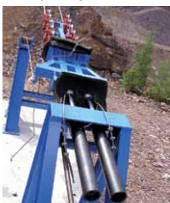
Предохранительные амортизаторы ACE разработаны для случаев аварийной остановки промышленной и подъемной техники. Они индивидуально настраиваются для каждого конкретного применения для чрезвычайной остановки.
