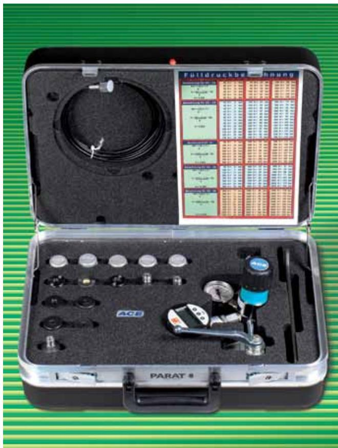
**Комплект для замены наполнения газовой пружины ACE** предлагает Вам возможность заполнять газовые пружины или индивидуально их настраивать прямо на месте. Комплект оборудован всеми необходимыми для заполнения пружины деталями. Очень точное заполнение газом возможно при использовании цифрового манометра. Стол для определения заполняющего давления газовых пружин включен в комплект вместе с чехлом. Единственное, что отсутствует в комплекте, это азот.
