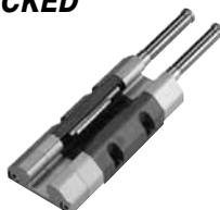
**Зажимные элементы LOCKED** от ACE предлагают самые высокие зажимные и тормозные усилия с самым коротким временем реагирования через систему пневматических преднагруженных пружинных пластин. Зажимные элементы подходят для прямого зажима и торможения на линейных направляющих, штоках и поршнях. Осевое и радиальное движение может быть оста-
