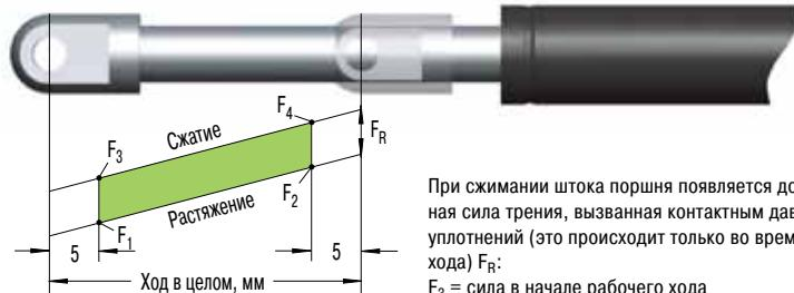
При сжимании штока поршня появляется дополнительная сила трения, вызванная контактным давлением уплотнений (это происходит только во время рабочего хода)  $F_R$ :
