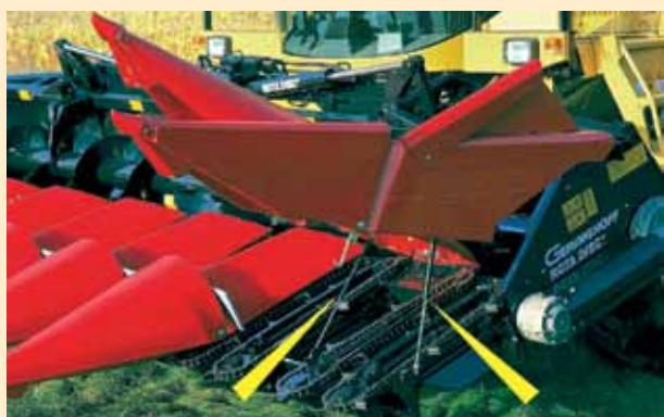
Промышленные газовые пружины поддерживают тяжелые крышки капотов
