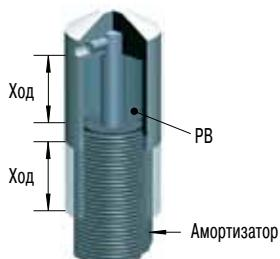
Металлические опилки, песок, окалина, краска, адгезивы и т.д. могут прилипать к штоку поршня. В этом случае они повреждают уплотнение штока, и амортизатор быстро выходит из строя. Во многих случаях установка дополнительного стального колпачка обеспечивает достаточную защиту и увеличивает срок службы амортизатора.
