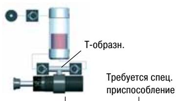
Масло рециркулирует, экстремально повышая высокочастотный темп. Нагретое масло свободно циркулирует по воздухомасляному бачку и усиливает теплоотдачу.
