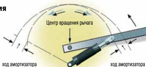
Можно использовать один амортизатор для двух конечных положений механизма, используя разные оси вращения.
