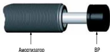
Эти новые ударные колпачки, изготовленные из полиуретана, обладают всеми преимуществами РР нейлоновых колпачков в вопросах сокращения шума и изнашивания. Они легко устанавливаются на шток поршня соответствующего амортизатора. Головка защищена пружинным кольцом, установленным в отверстии, просверленном в стальном основании. Пожалуйста, обратитесь к таблице комплектующих на страницах с 32 по 33 и узнайте, для каких амортизаторов доступны новые BP колпачки.
