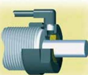
Срок службы амортизатора в агрессивных условиях может быть значительно увеличен при использовании воздухонапорного адаптера. Адаптер, при подаче в него воздуха низкого давления, защищает уплотнения амортизатора от смазывающих-охлаждающих жидкостей, моющих средств, кухонных жиров и т.п.
