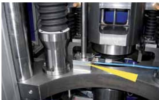
Зажимные элементы LOCKED от ACE предлагают самые высокие зажимные и тормозные усилия с самым коротким временем реагирования через систему пневматических преднагруженных пружинных пластин. Зажимные элементы подходят для прямого зажима и торможения на линейных направляющих, штоках и поршнях. Осевое и радиальное движение может быть остановлено или замедлено с помощью этих элементов.
