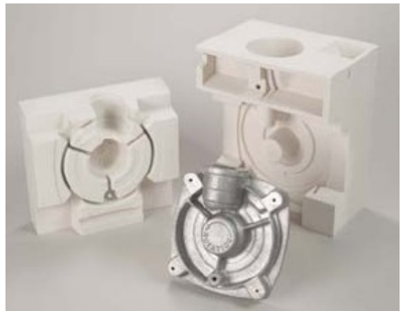
Напечатанная форма ZCast и полученная с ее помощью алюминиевая отливка
