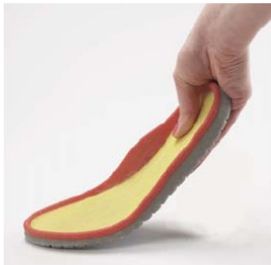
Пример модели, напечатанной из эластичного материала
